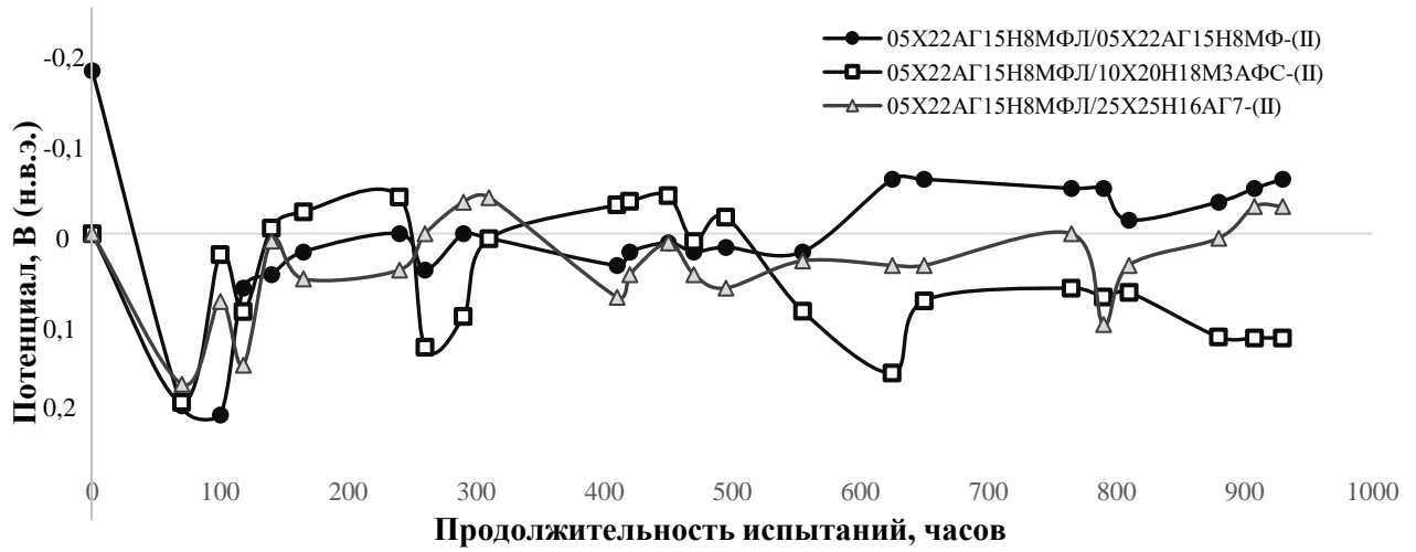
Рис. 3.52 – Измерение потенциалов коррозии образцов СС.
